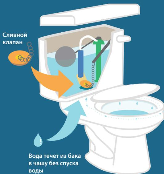
Утечка в унитазе обычно вызвана утечкой воды из бака в чашу через сливной клапан (резиновый клапан на дне бака).
